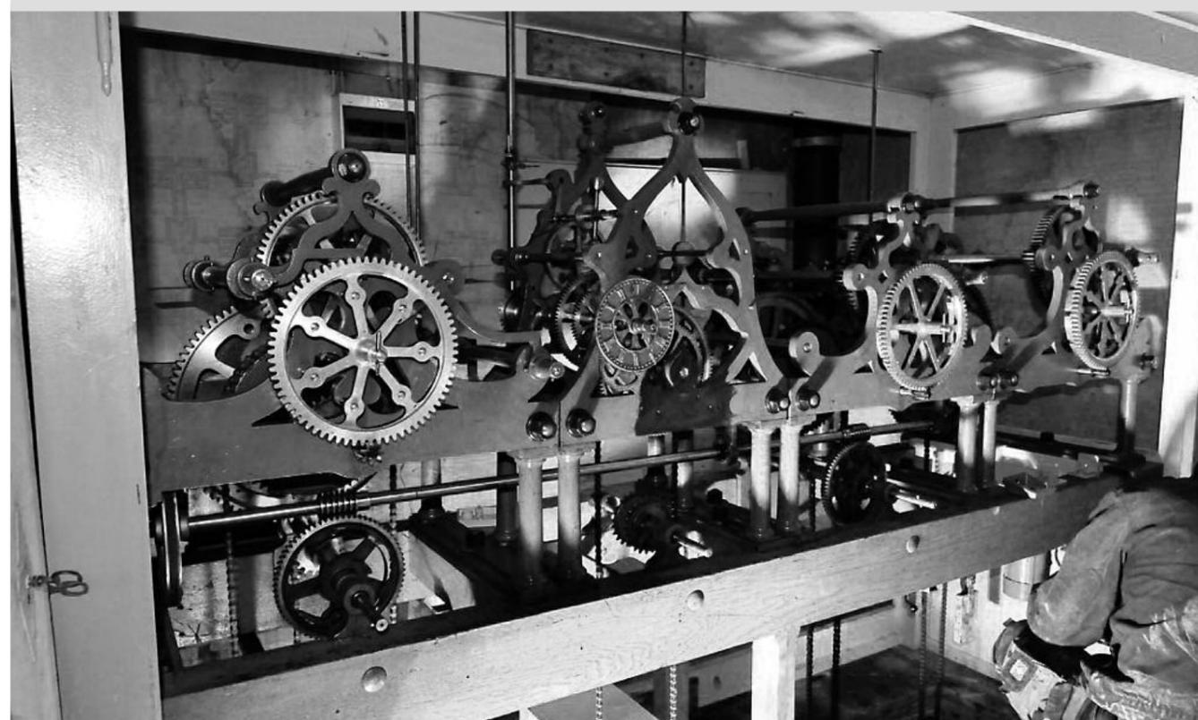
Das gesamte Uhrwerk kurz vor Inbetriebnahme. Links der erste Teil für den Viertelstundenschlag, Teil 2 steuert das Uhrwerk, Teil 3 ist für den Stundenschlag zuständig und der vierte Teil für die Repetition des Stundenschlages. Das Ganze ist in einer engen Kabine untergebracht, damit es vor Staub und Schmutz geschützt ist. (Fotos: Christian Bosshard)
